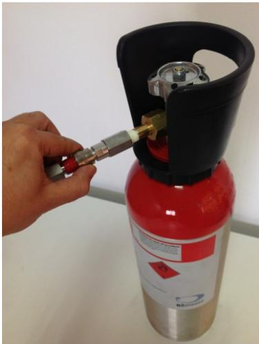
3. Spurgare una piccola quantità di miscela aria/idrogeno dal tubo connesso alla sorgente di idrogeno mediante una breve pressione sul connettore maschio fornito, **prima di connetterlo alla cartuccia**. Questo consente di eliminare eventuali gas contaminanti come l'azoto o l'ossigeno presenti nell'aria.
