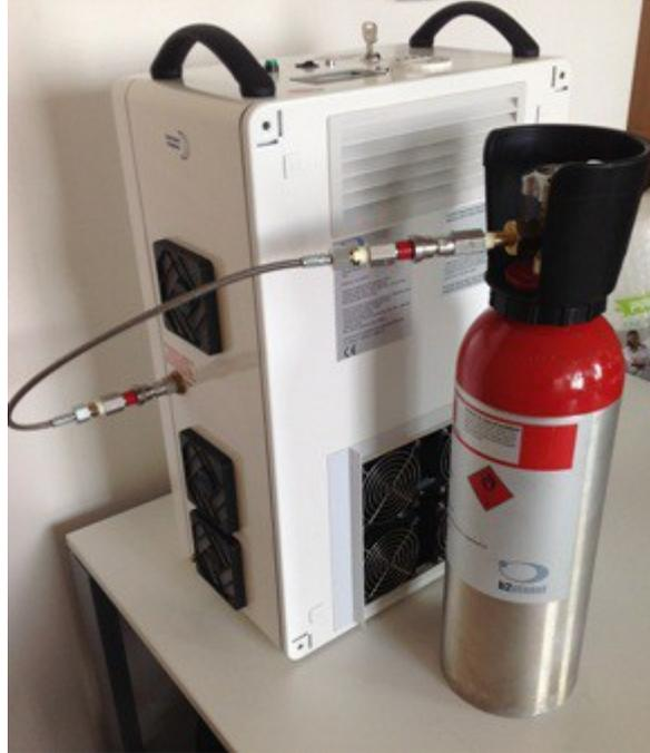
4. Spegnere il dispositivo che sta utilizzando l'idrogeno e chiudere la manopola nera/metallica della valvola ruotandola in senso orario.
